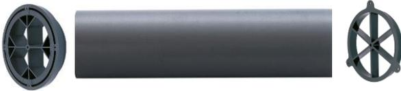
•両面 パイプ仮枠止ご使用の際は、壁厚(コンクリートの厚み)から5mm控えた寸法でお願い致します。
